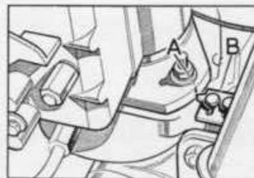
Fig. 78. Referencias en la bomba de inyección para la puesta a punto.
