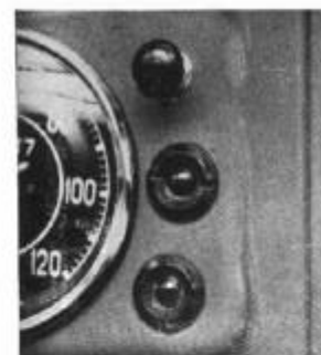
Fig. 17. Luces de aviso de nivel de combustible (azul) y del estrangulador (ámbar), en el motor de gasolina, y de las bujías de caldeo en el Diesel.
