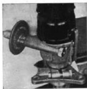
Fig. 62. Dispositivo de avance por vacío y selector de octano del distribuidor.
