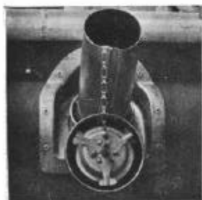
Fig. 25. Tapón y cuello para llenado del depósito.
