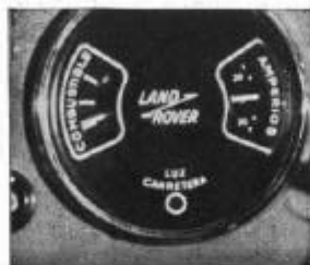
Fig. 18. Luz de aviso de los faros de carretera.
