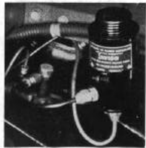
Fig. 68. Depósito común para el sistema hidráulico de los frenos y embrague.
