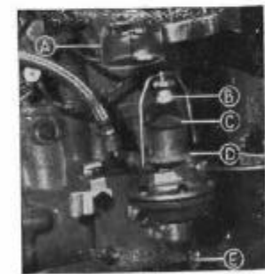
Fig. 50. Filtro y vaso de sedimentación de la bomba de gasolina.
