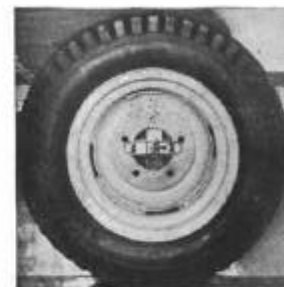
Fig. 27. Sujeción de la rueda de repuesto dentro de la caja del vehículo.
