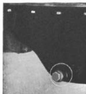
Fig. 31. Tapón de vaciado del cárter del motor.
