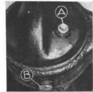
Fig. 40. Tapones de llenado, nivel y vaciado del diferencial delantero.
