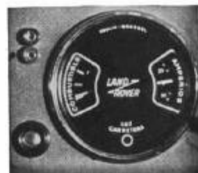
Fig. 19. Amperímetro, indicador de nivel de combustible y enchufe para luz auxiliar.
